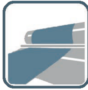
Walzen und Schneiden: Verdichtung der Elektroden und Zuschnitt der Folie
